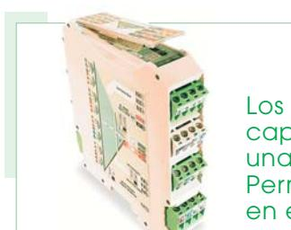
Los multiplexores de RTDs permiten controlar varios puntos de captación de temperatura, con aislamiento e independientes, con una sola señal analógica de entrada del PLC. Permiten regular, indicar y registrar los parámetros que intervienen en el proceso.
